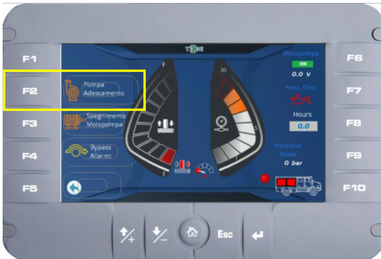
Figura 14 - Spegnimento pompa di adescamento
