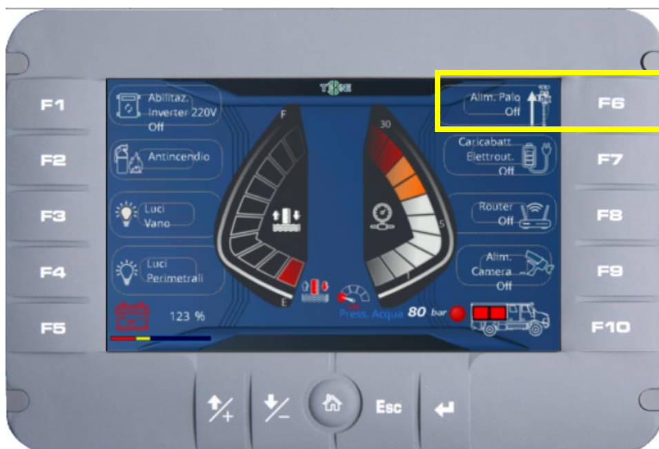
Figura 39 - Alimentazione palo da Tera7
