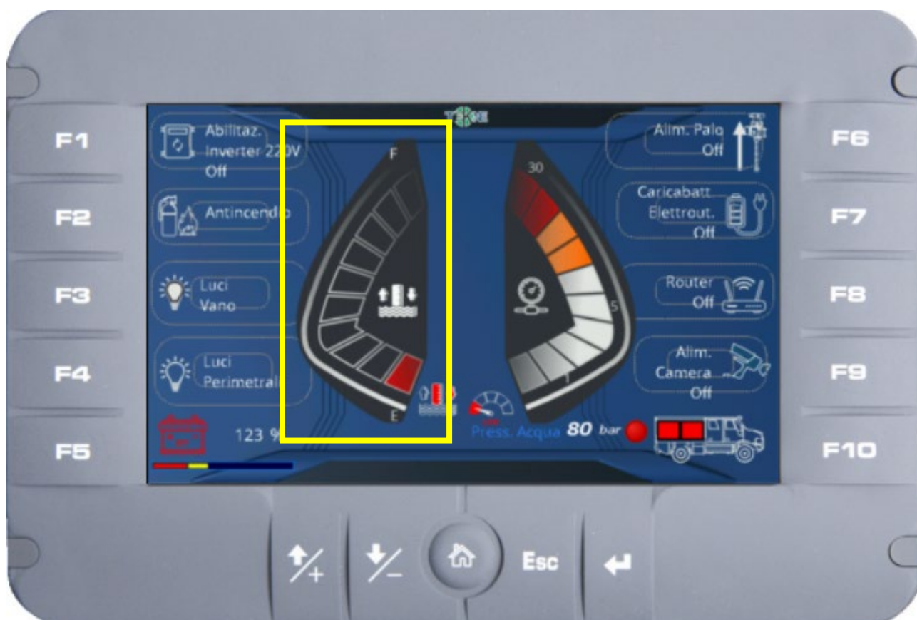
Figura 9 - Livello acqua serbatoio
