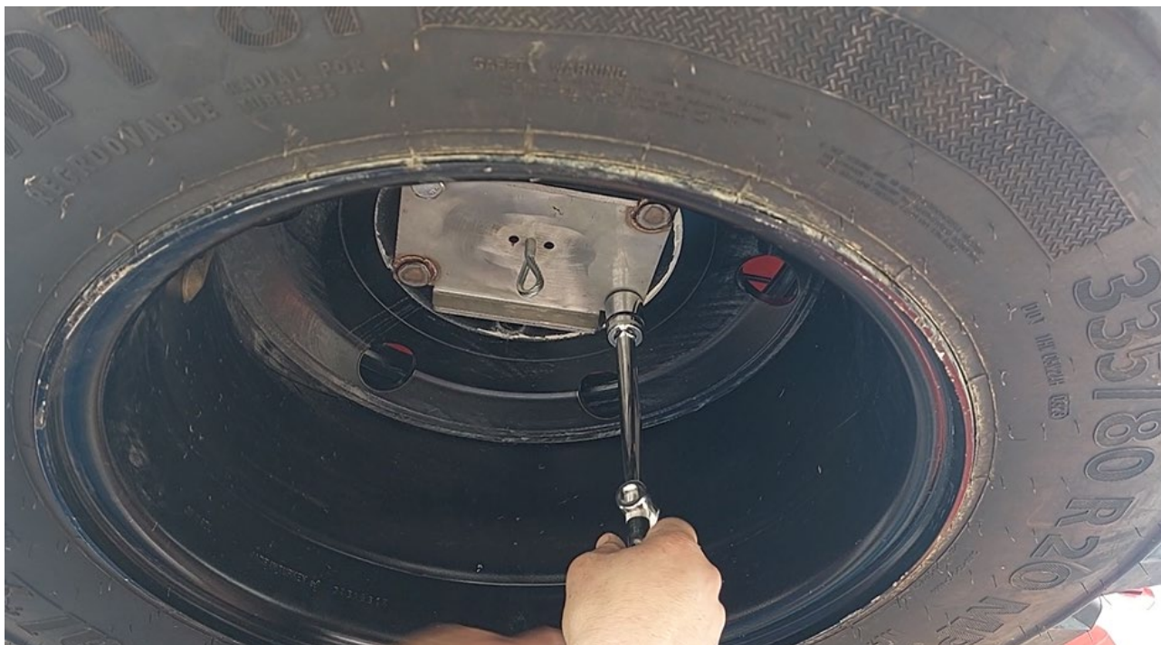
Figura 48 - Rimozione bulloni di fissaggio
